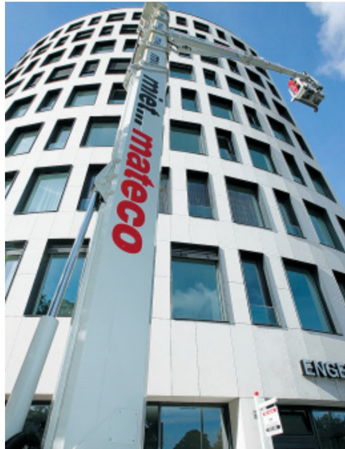
Am Teleskop-Arm: Mit dem „Leo 500“ können die Gebäudereiniger in einer Höhe von bis zu 50 Metern arbeiten.
