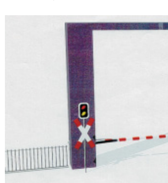
Tor zur anderen Campus-Seite: Diese Stahlkonstruktion mit „Taschenmesserprinzip“ für die Schranke ist am neuen Übergang geplant.
